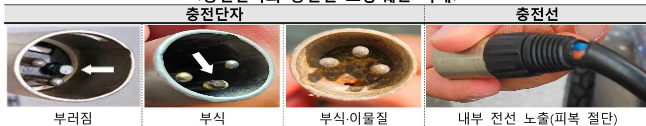
26개 충전기 가운데 공원 등 야외에 설치된 시설은 8개였으며, 이 중 25.0%(2개)가 부식되고 먼지 · 거미줄로 뒤덮여 관리 상태가 미흡했다. 전류를 공급하는 충전기를 야외에 설치할 때는 외부 환경에 영향을 받기 쉬우므로 안전을 위해 정기적인 청결 유지와 관리가 필요하다.
